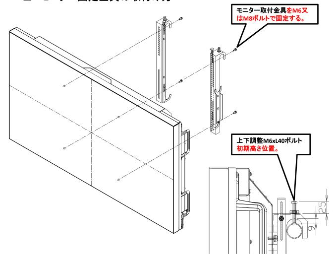
1、モニターにモニター取付金具を付属六角セムスネジ(M6x15又はM8x15) 4本で(又はモニターに合ったネジを用意、使用する事)取付ける。
